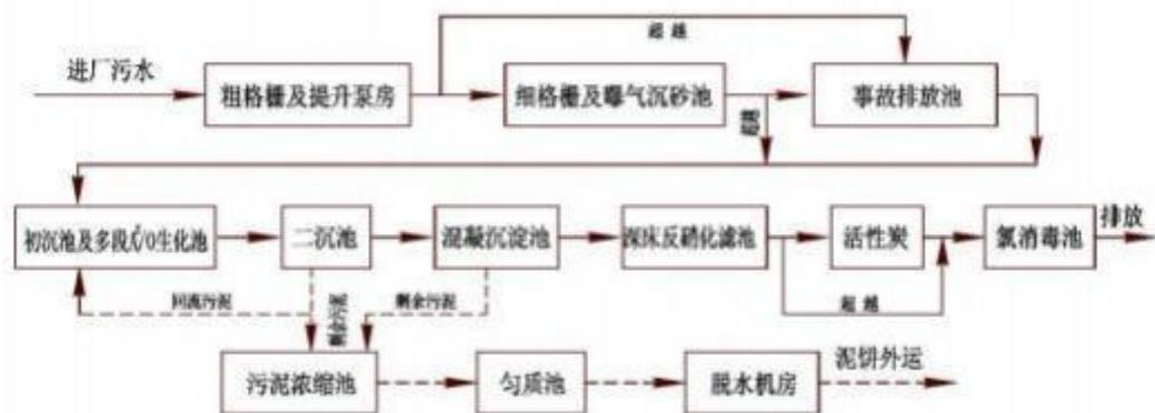
图 4.2-1 江苏中法水务股份有限公司（城东水质净化厂）污水处理工艺流程图
