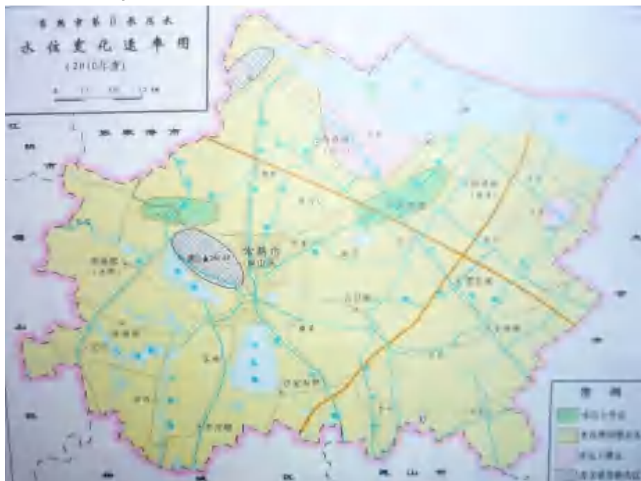
图 5.1.6-2 第Ⅱ承压水水位变化速率
