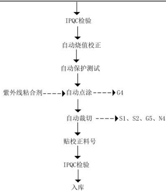
图2-3 锂离子电池生产过程和产污环节图
