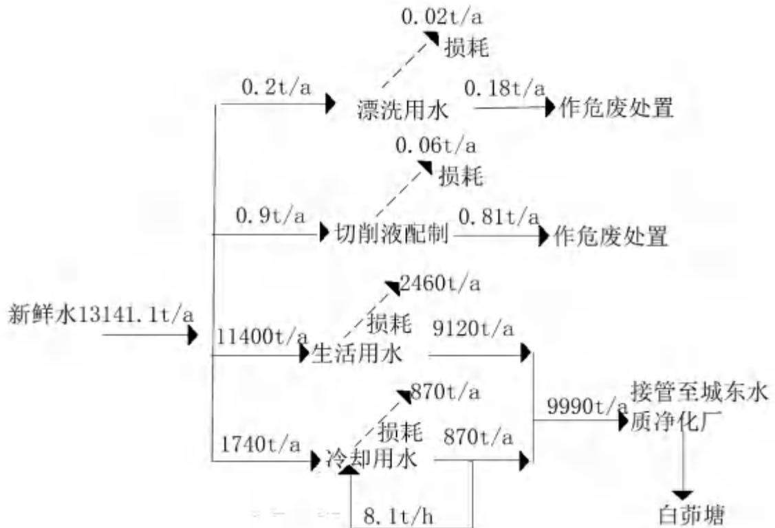
图 2-3 扩建后全厂水平衡图 (单位: t/a)
